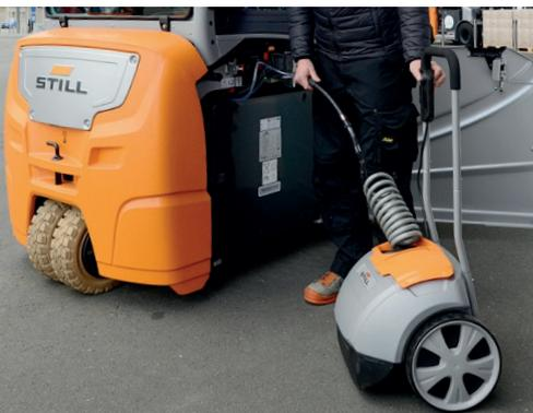
...und ein aufwendiges Anheben (bis 4 m) des Nachfüllbehälters, für den erforderlichen Wasserdruck von bis zu 0,4 bar, entfällt.
