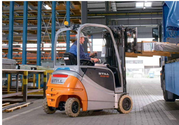
Les chariots avec accu Lithium-ion séduisent par une efficacité plus grande et sont particulièrement adaptés pour l'utilisation avec plusieurs équipes. Un changement de batterie n'est pas nécessaire grâce au biberonnage possible.
